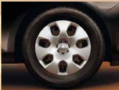
1 Jante din oțel cu capac, 6.5J x 16 și 7J x 17, pneuri 205 (215)/60 R 16 sau 215 (225)/50 R 17 (PWM/PWP).
